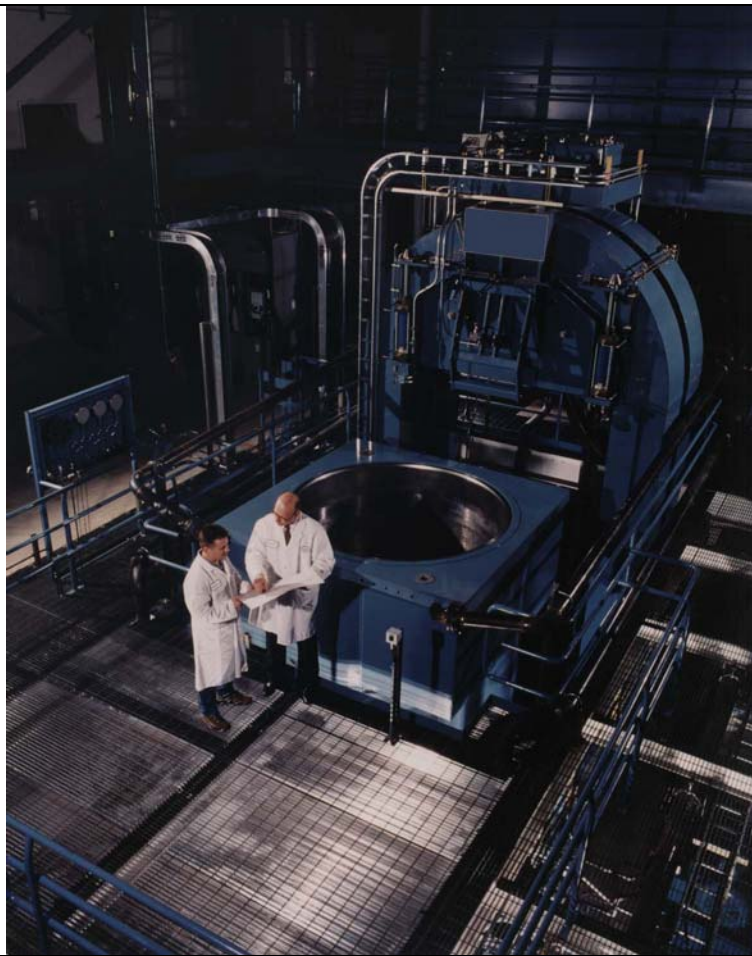
ワシントン州カマスに有るこの直径 1.63 メートルの HIP ユニットは、ITER プロジェクトの部品を効率の良い方法で処理する為に必要な巨大で精巧な装置の実例です。
